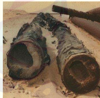
Gambar 2.1(b) Scale di dalam pipa produksi
