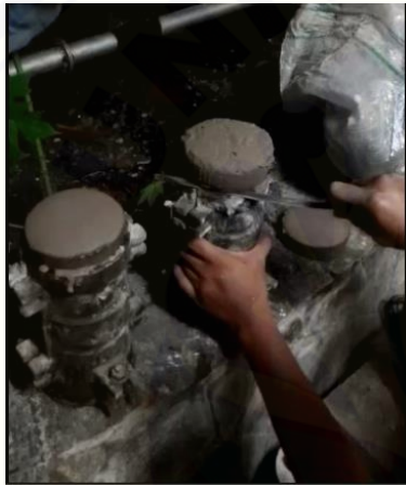
Proses pemotongan benda uji yang mengembang
