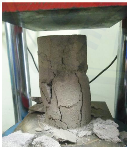
Proses pengujian kuat tekan
