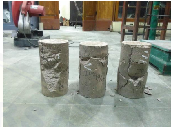
Benda uji setelah mengalami pengujian kuat tekan
