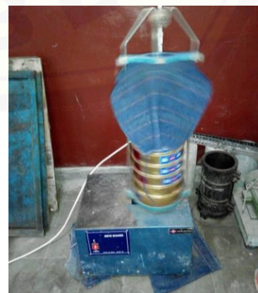
Pengujian analisa saringan pasir
