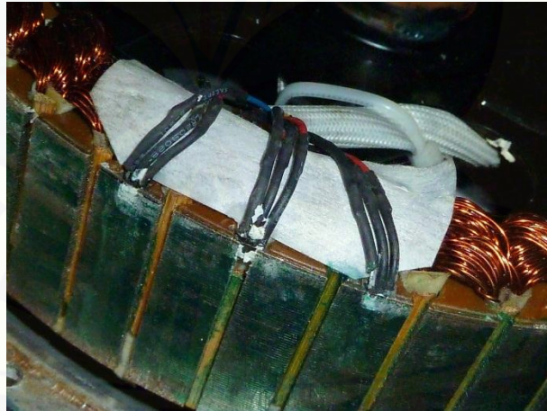
Gambar 2.5 Penempatan sensor medan magnet pada stator
