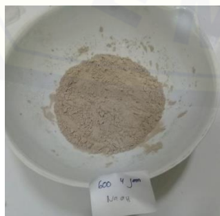
Prekursor silika berbasis abu ampas tebu disintering suhu 600^{\circ}\text{C} 4 jam
