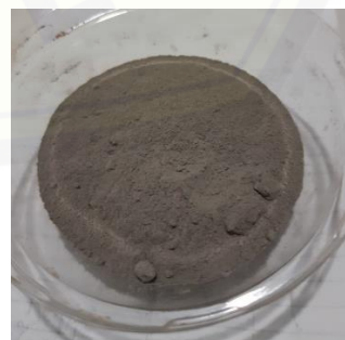
Prekursor silika berbasis abu ampas tebu disintering suhu 900^{\circ}\text{C} 4 jam
