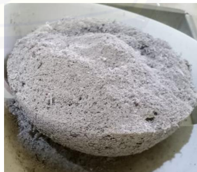
Sintering suhu 900 °C selama 4 jam
