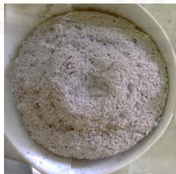
Sintering suhu 600°C selama 4 jam
