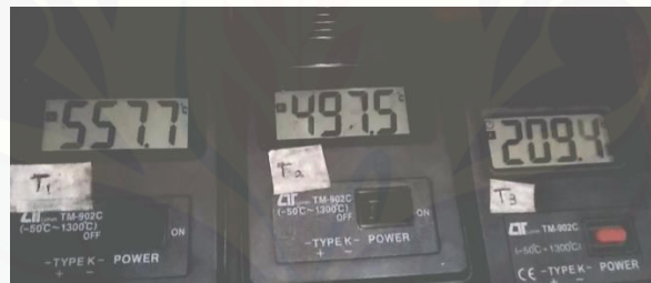
Gambar A.14 Pengukuran temperatur api percobaan ke-2 pada bahan bakar B100
