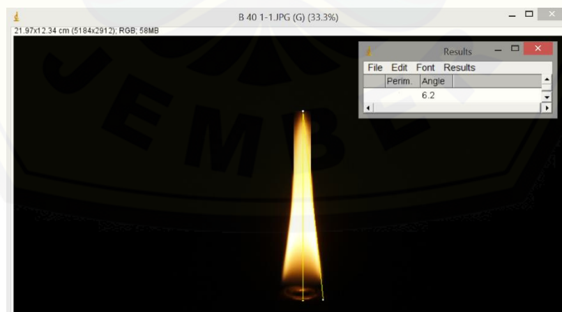
Gambar A.40 Pengukuran sudut api percobaan ke-1 pada bahan bakar B40
