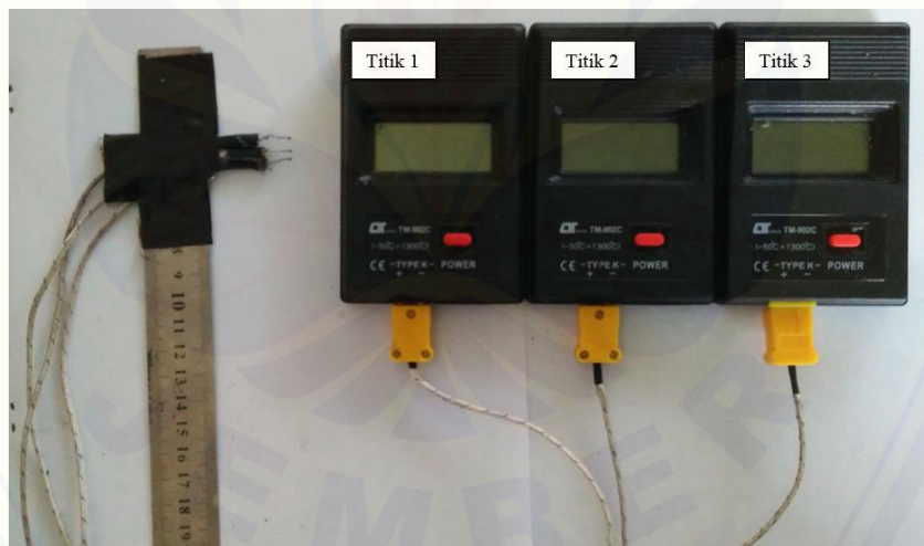
Gambar 3.7 Pengambilan data temperatur api
