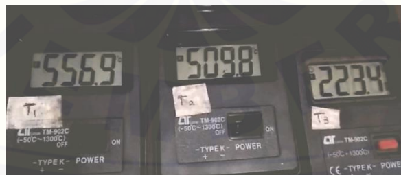
Gambar A.15 Pengukuran temperatur api percobaan ke-3 pada bahan bakar B100
