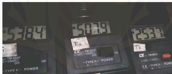
Gambar A.10 Pengukuran temperatur api percobaan ke-1 pada bahan bakar B40
