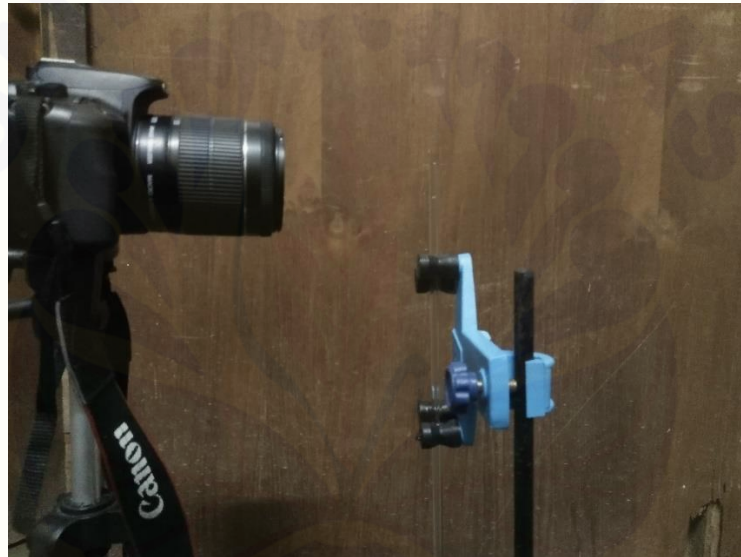
Gambar 3.6 Pengujian tinggi api dan kecepatan pembakaran
