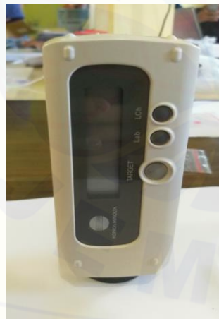
Pengukuran warna sampel sebelum perendaman
