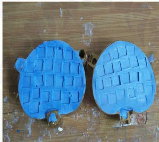
Mould space sudah terbentuk
