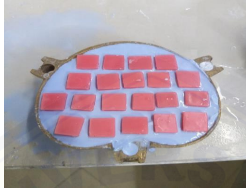
Proses penanaman model malam ke dalam kuvet berisi gipsium
