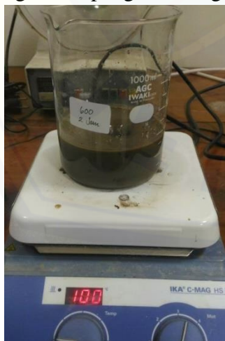
10 gr abu ditambah larutan NaOH 2 N 60 ml dan diaduk dengan alat pengaduk otomatis hingga mendidih
