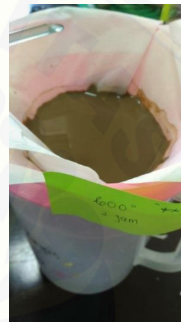
Disaring dan dibilas dengan akuades hingga pH 7 kemudian dikeringkan dalam oven
