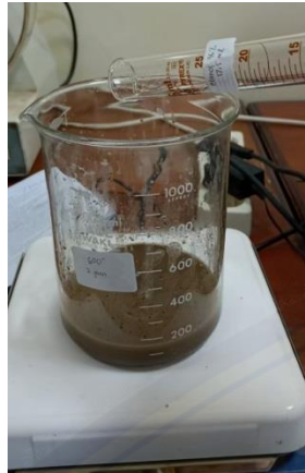
Mencampur natrium silikat dengan akuades, 2,5 ml etanol 96% dan diaduk dengan alat pengaduk magnet
