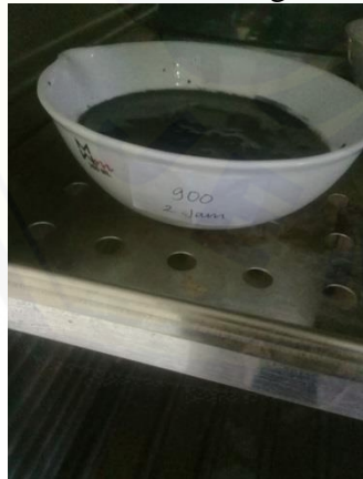
Mengeringkan dalam oven bersuhu 60°C selama 72 jam
