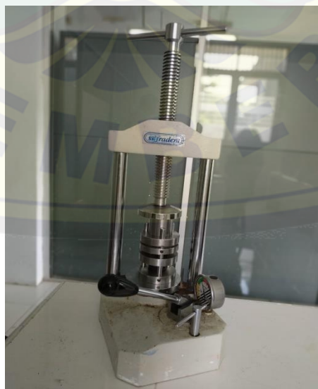
Gambar 3.2 Cetakan Stainless steel pada Press hidrolik (Dokumen Pribadi, 2018)
