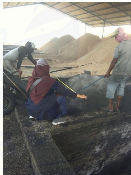
Gambar 8. Pengukuran jarak pekerja terhadap sumber panas
