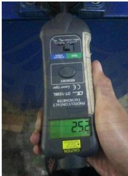
Gambar 3.6 *Tachometer digital*
