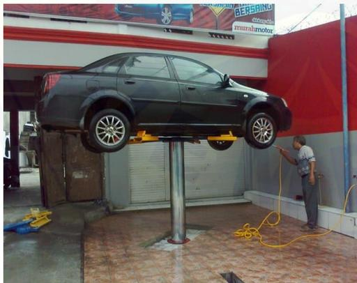
Gambar di samping menunjukkan gambar di suatu tempat pencucian mobil. Untuk membersihkan bagian bawah mobil yang kotor, mobil biasanya diangkat dengan menggunakan pompa hidrolik. Bagaimanakah cara kerja dari pompa hidrolik tersebut?
