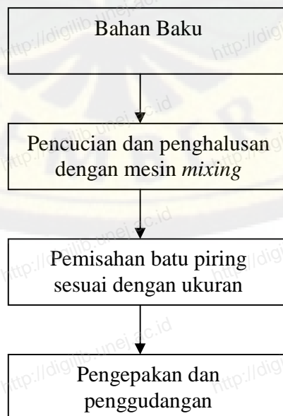
Gambar 3.2 Tahap Proses produksi batu piring jenis I Sumber : UD. Rahamat Jaya, 2007
