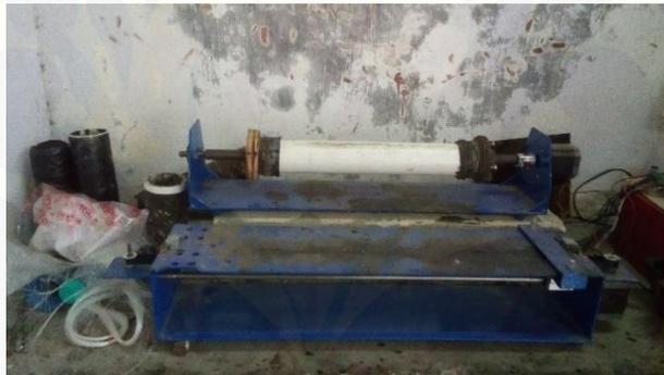
Gambar 3.1 Mesin *fillament winding*.
