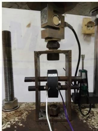
Gambar B18. Pengujian *thermal* mekanis.
