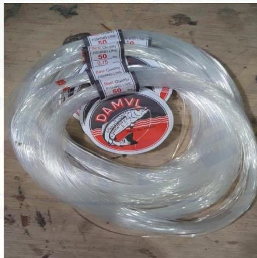
Gambar 3.9 Benang polietilen (PE).
