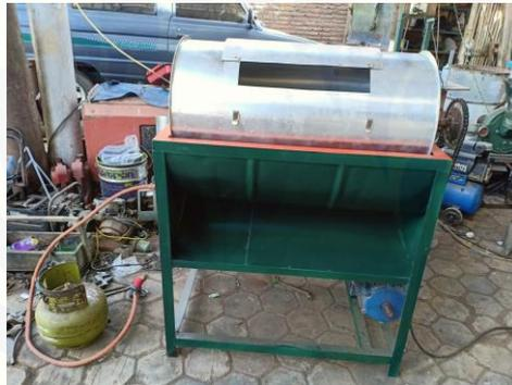
Gambar C.23 Hasil akhir mesin pengering biji kakao dengan mekanisme *rotary*
