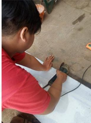
Gambar C.12 Proses pemotongan plat
