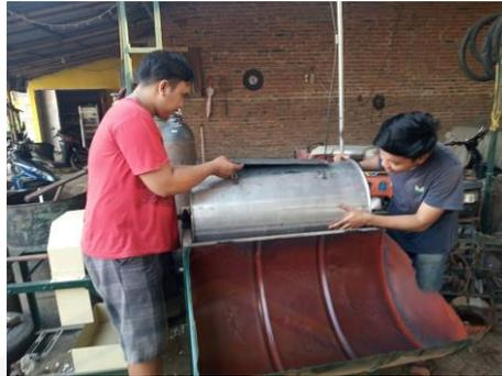
Gambar C.18 Proses pemasangan clamp pengunci tutup tabung
