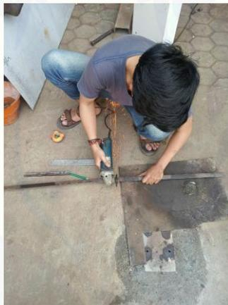
Gambar C.10 Proses pemotongan besi
