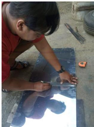
Gambar C.11 Proses pengukuran plat
