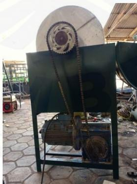
Gambar C.23 Proses pemasangan sproket dan rantai
