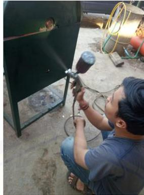
Gambar C.22 Proses pengecatan mesin
