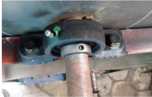
Gambar C.15 Proses pemasangan bearing dan poros
