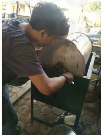
Gambar C.16 Proses pemasangan tabung slinder
