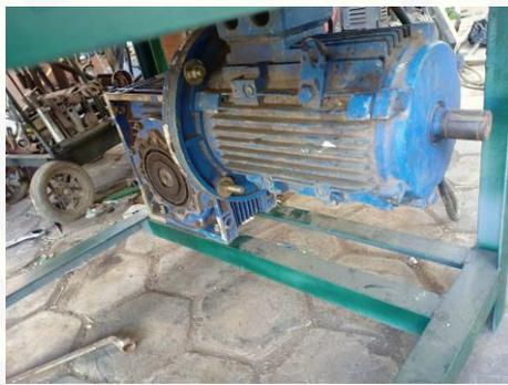
Gambar C.22 Proses pemasangan motor listrik
