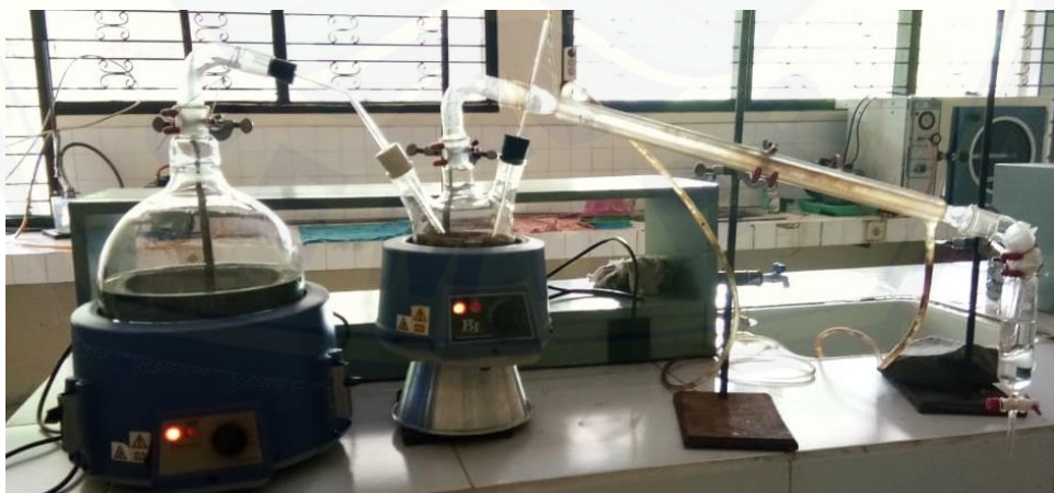
Gambar 3.1 Set alat distilasi uap (Dokumentasi pribadi, 2018)
