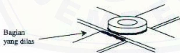
Gambar B.10 Bagian yang dilas pada baling-baling
