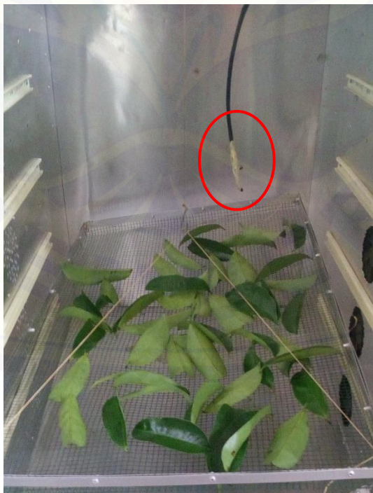
Gambar Pemasangan Sensor LM35
