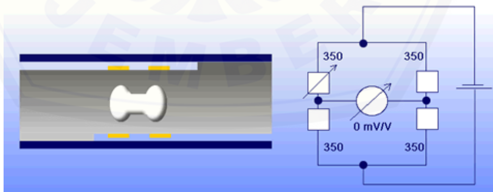
Gambar 2.16 Rangkaian Load Cell tanpa beban (Sumber : Rebby Fudi Alexander.2013. Aplikasi sensor Berat Load Cell Pada Alat Pengering Herbal )
