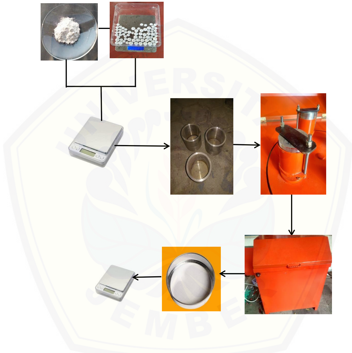
Gambar 3.2 Skema proses pengayakan partikel ZnO
