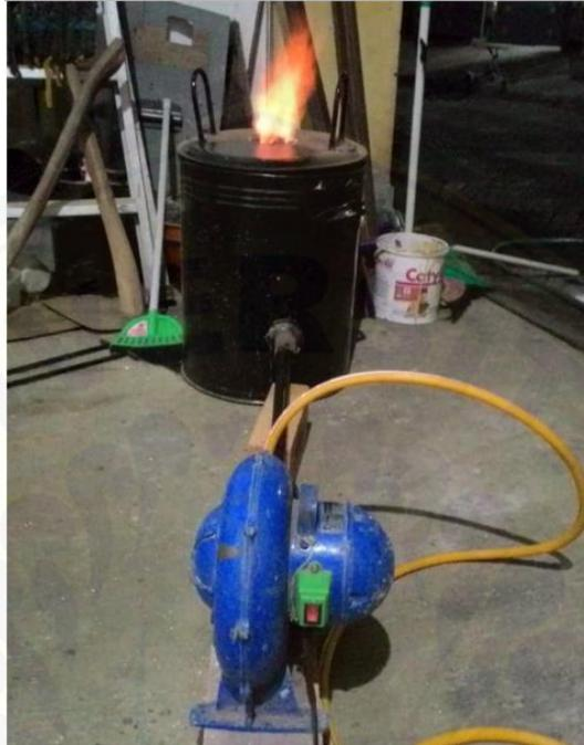
**Lampiran 7 Proses fabrikasi pengecoran logam**
