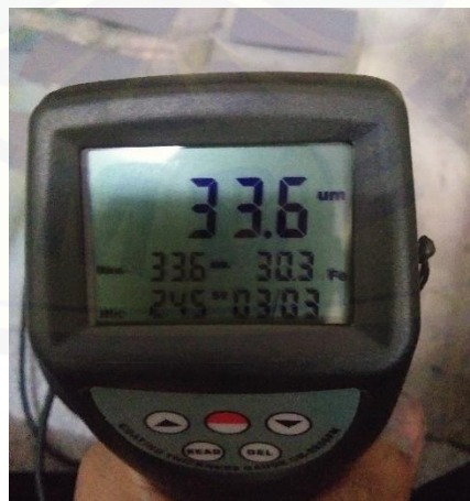
Gambar 3. 4 Proses pengukuran ketebalan pada spesimen nomor 11
