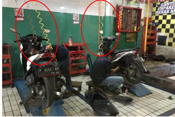
Gambar 4. Sumber kebisingan berupa kompresor (lingkaran merah)
