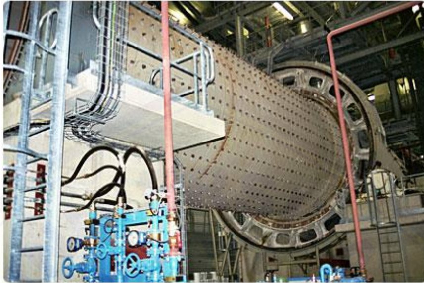
Gambar 2.3 horizontal ball mill (Kartikasari, 2007:19)
