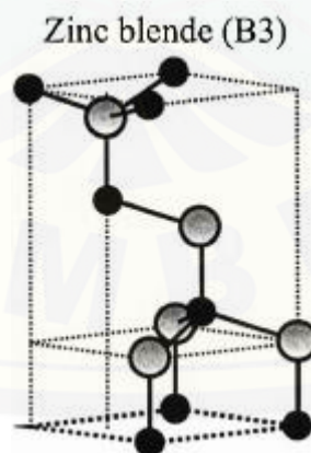
Gambar 2.11 Struktur zincblende pada ZnO. Atom O ditunjukkan dengan bulatan putih dan Atom Zn dengan bulatan hitam (Ozgur et al. , 2005)
