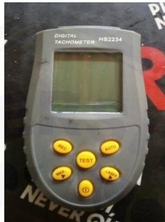
Gambar 2.8 Tachometer (Sumber: Laboratorium Konversi Energi)
