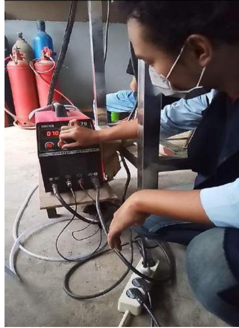
Gambar Setting parameter arus Plasma
