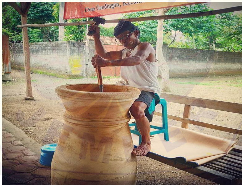
Gambar H 4. Proses pembuatan kendang dhodhog besar Sumber : Dokumentasi Yuyun Handayani
