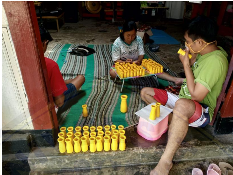
Gambar H 7. Proses pewarnaan gantungan kunci berbentuk kendang dhodhog
