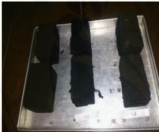
g. Pengeringan briket menggunakan oven
