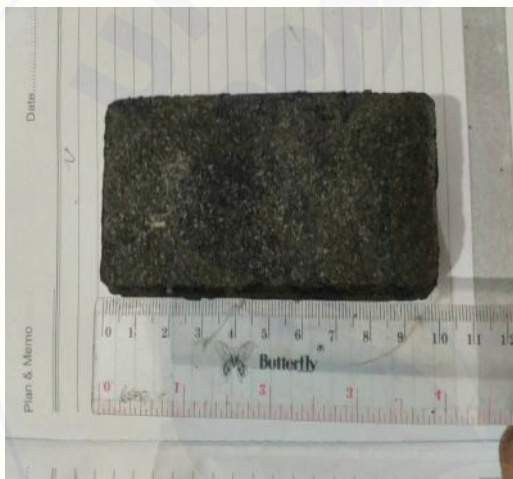
k. Pengukuran volume briket
