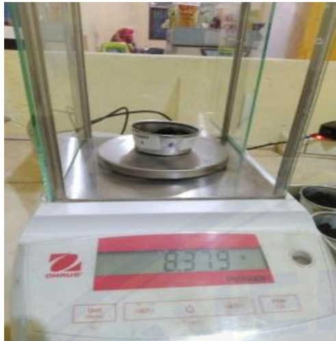
i. Penimbangan bahan pengujian kadar air
