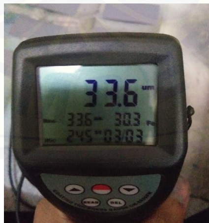
Gambar 3. 4 Proses pengukuran ketebalan pada spesimen nomor 11
