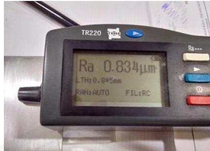
Gambar 3. 3 Proses pengukuran kekasaran permukaan pada spesimen C3
