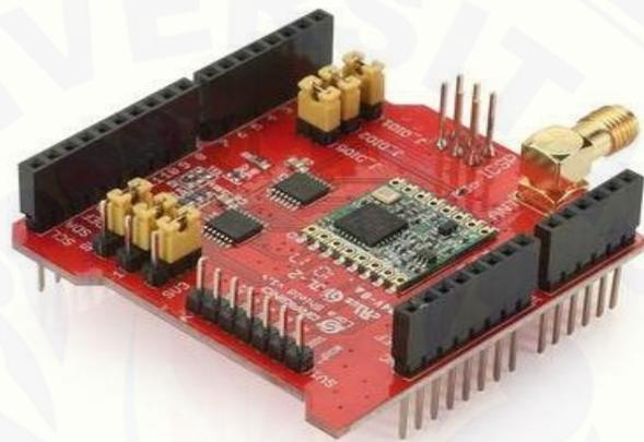
Gambar 2.11 *LoRa Shield* dengan modul *SX1278*
