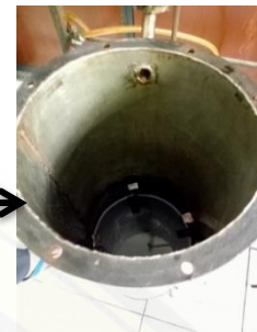
Dilakukan pengisian air sebanyak \frac{3}{4} tabung destilasi.
