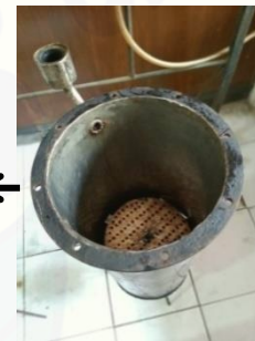
Tabung destilasi ditutup menggunakan loyang berlubang.
