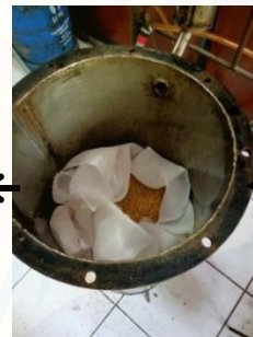
Biji ketumbar dimasukkan ke dalam tabung destilasi dengan posisi tepat di atas loyang berlubang.
