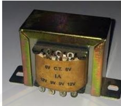
Gambar 2. 5 Trafo 1 ampere (Sumber: dokumen pribadi)
