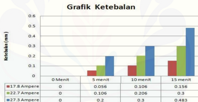
Gambar 2. 10 Hasil uji ketebalan dengan variasi arus dan waktu (Sumber: Darmawan dkk, 2015)
