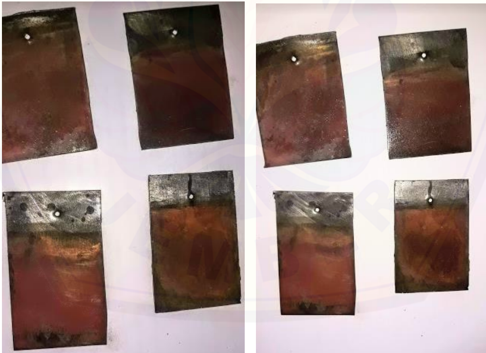
Hasil electroplating tembaga pada tin-plate
