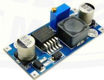
Gambar 2. 7 DC step down module 5 ampere (dokumen pribadi)
