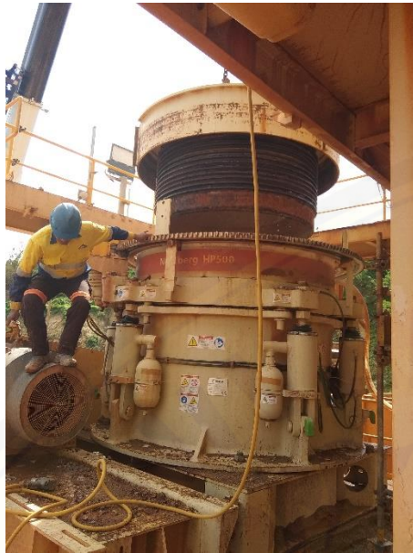
Lampiran 4.4 Dokumentasi Pembongkaran Bowl dan Head Liner Cone Crusher
