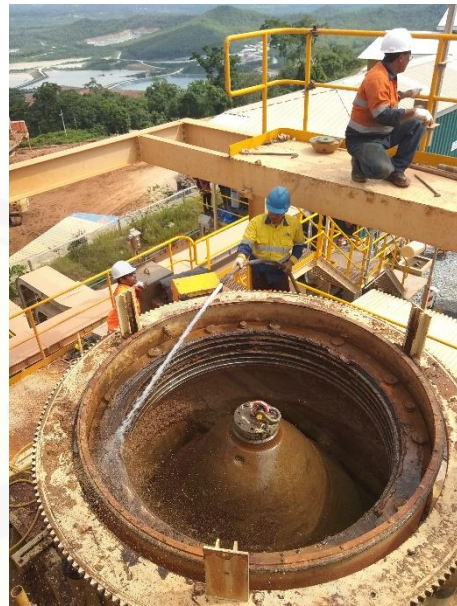
Lampiran 4.4 Dokumentasi Pembongkaran Bowl dan Head Liner Cone Crusher
