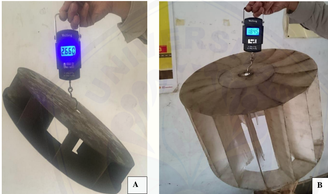
Lampiran 6.8 Gambar perbandingan massa impeller lama dan baru
