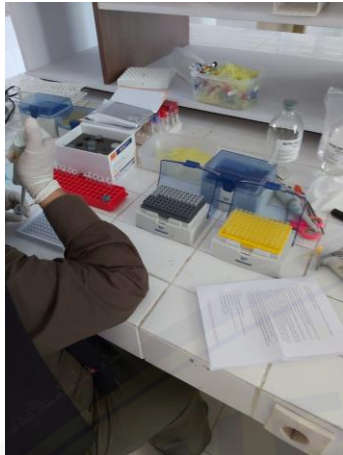
Gambar 5. Analis menambahkan substrat A dan B ke dalam well , lalu setelah inkubasi analis menambahkan stop solution ke dalam well
