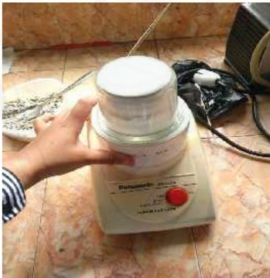
Gambar 3. Pembuatan serbuk cangkang telur puyuh dengan menggunakan blender
