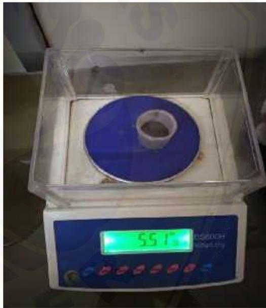
Gambar 8. Menimbang serbuk cangkang telur puyuh menggunakan timbangan analitik masing-masing sebesar 1,5 g, 3,5 g dan 5,5 g.
