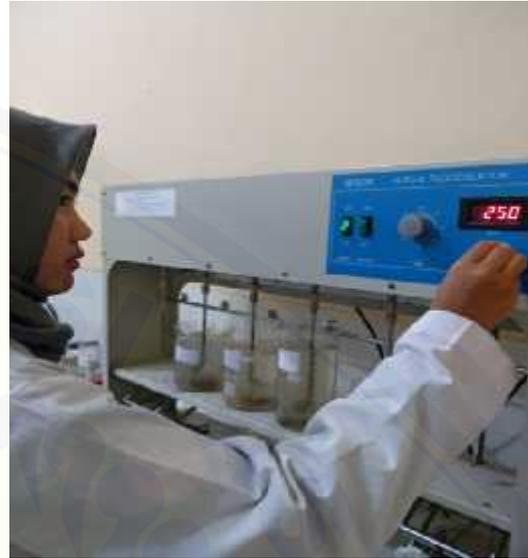
Gambar 10. Mengaduk air sumur yang sudah ditambahkan serbuk menggunakan jar test dengan kecepatan 250 rpm selama 10 menit
