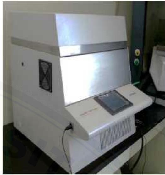
Gambar 6. Proses aktivasi dengan *furnace* suhu 800°C
