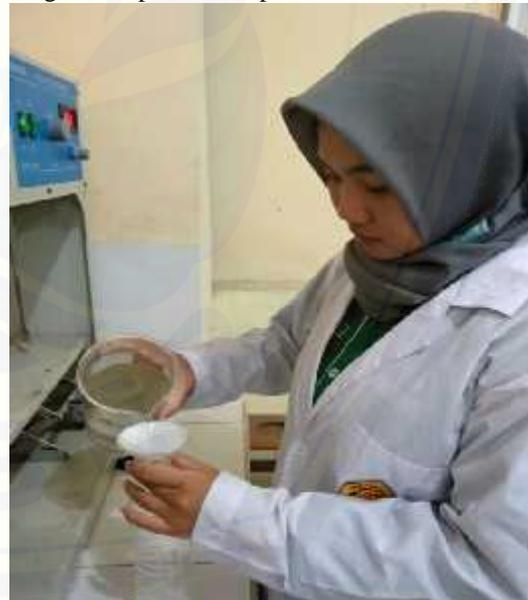
Gambar 12. Penyaringan serbuk cangkang telur puyuh dan air sumur menggunakan kertas saring whatman no.42 diameter 125mm
