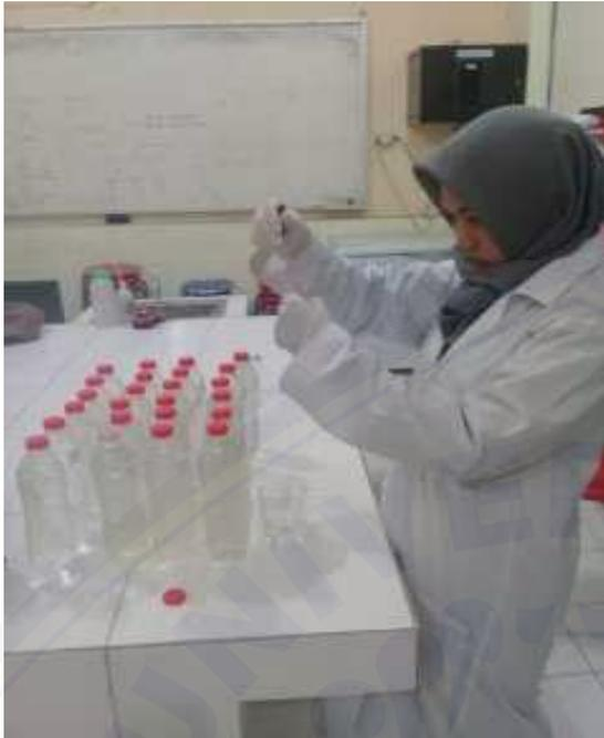
Gambar 13. Hasil penyaringan di masukkan kedalam botol dan di tambahkan  $\text{HNO}_3$
