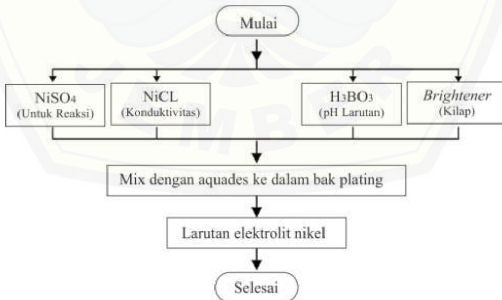
Gambar 3.6 Diagram alir pembuatan larutan elektrolit
