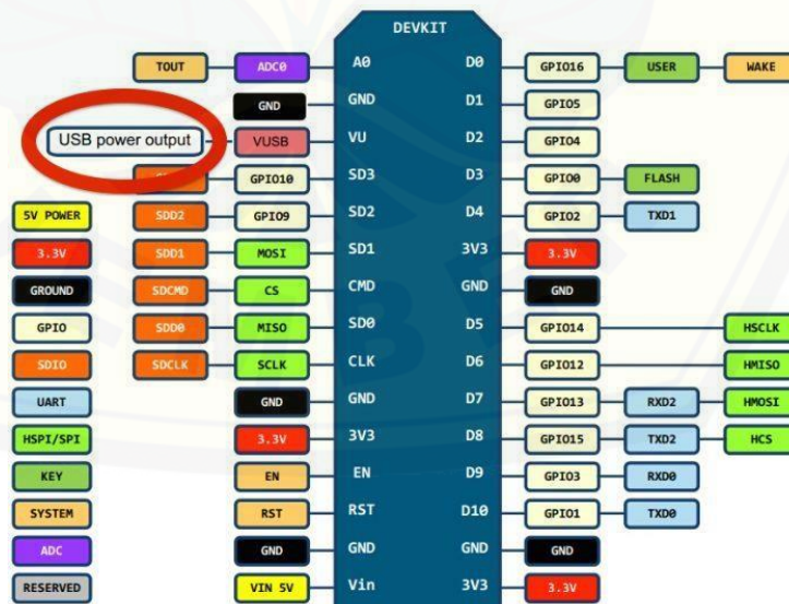
Gambar 2.13 Pin I/O pada nodeMCU (sumber : Priyono, 2017)
