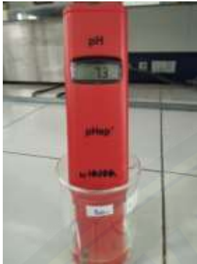
Perendaman pH meter pada larutan buffer
