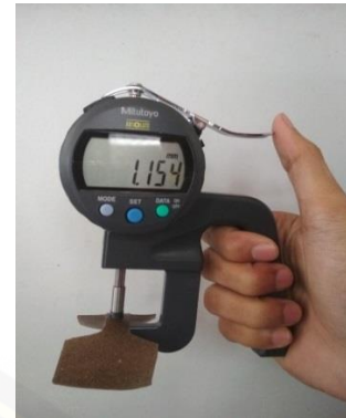
Gambar E.18 Uji ketebalan
