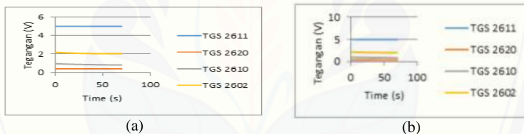
Gambar 2.7 Respon gas sensor array (a) aroma campuran kopi Arabika dan Robusta; (b) udara bebas (tanpa kopi) (Susanti et al. , 2018)
