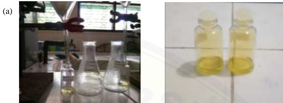
Gambar 3.17 Proses penyaringan larutan dengan kertas saring (a) dan hasil penyaringan (b)
