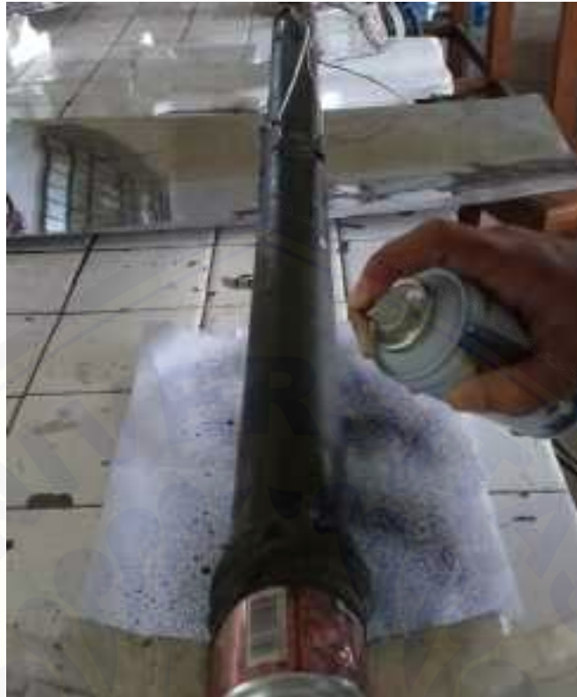
Gambar lampiran e). Pengecatan dengan pilok
