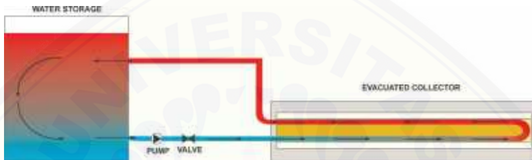
Gambar 3.3 Rencana desain alat pemanas air tenaga matahari
