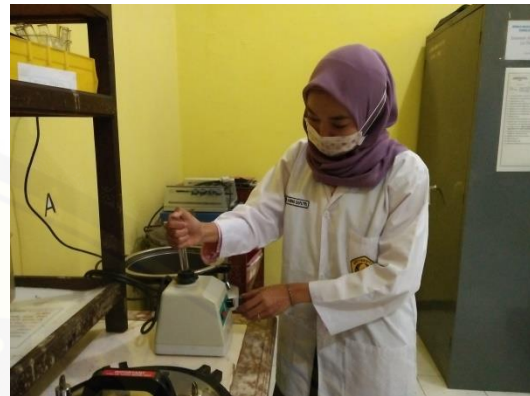
Memvorteks sampel agar homogen dengan aquades saat pengenceran
