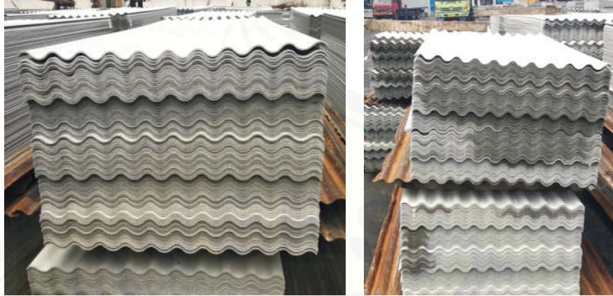
Lampiran 11: Asbes gelombang yang memiliki ketebalan diluar standar
