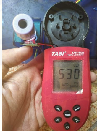
Gambar 3.12 Kalibrasi sensor dengan Lux meter
