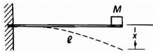
Gambar 2.12 Skema pembebanan pada batang kantilever (sumber: Leckie dan Bello, 2009)
