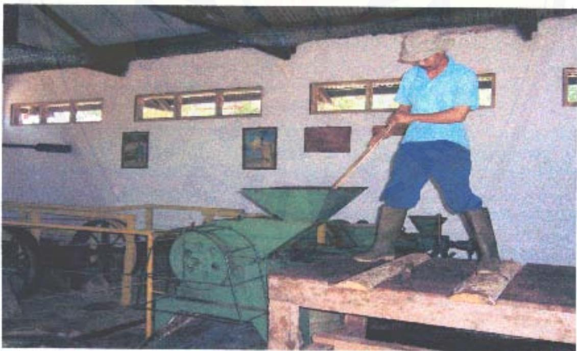
Gambar 6. Proses Pemotongan Kclapa Dengan Mesin Shreeder Setelah Dikeringkan
