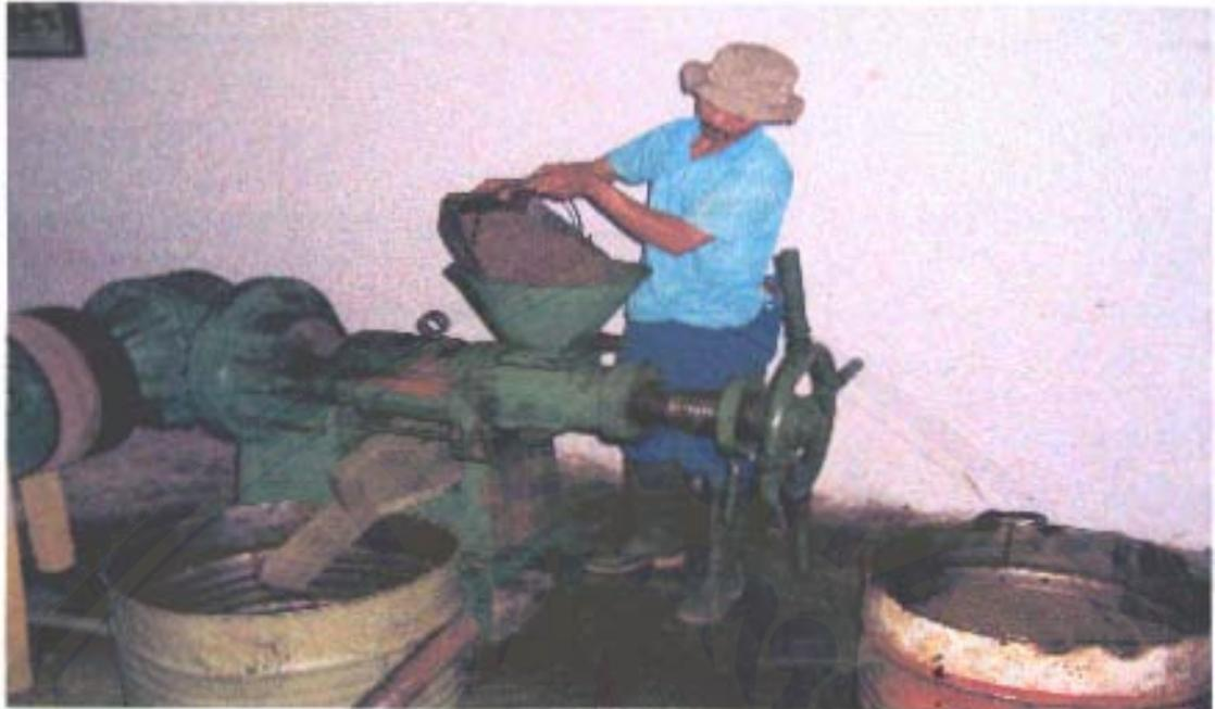
Gambar 9. Proses Pengepressan Kopra Dengan Mesin *Screw Press*
