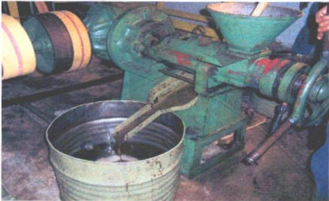
Gambar 11. Hasil Press dari Mesin *Screw Press*
