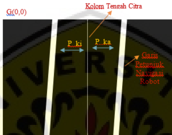
Gambar 7. Ilustrasi Sebuah Citra Biner Berukuran 320x240 dengan Parameter yang digunakan untuk Menentukan Pergerakan Robot
