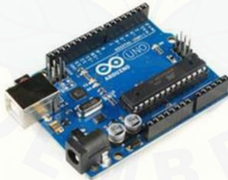
Gambar 2.7 Bentuk Fisik Arduino Uno R3 ( www.Arduino.cc )
