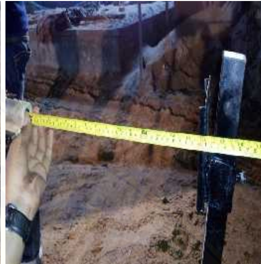
Pengukuran jarak penembakan dari nozzle ke spesimen
